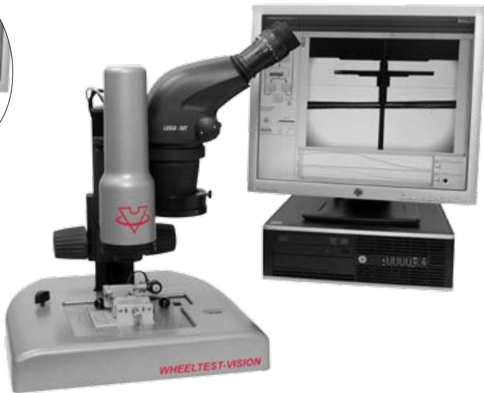
Binoculaire intégré pour une manipulation aisée des composants
